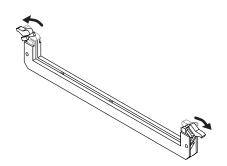
**4.** Prenez bien note de l'emplacement et de l'orientation de l'encoche du module de mémoire et insérez-le verticalement à l'intérieur des guides qui se trouvent de chaque côté de la prise.
